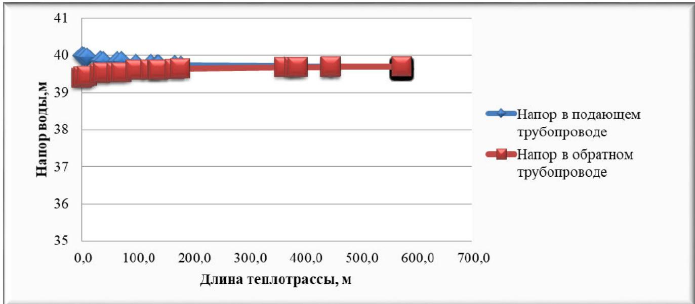
Рисунок 2.6 – Пьезометрический график тепловой сети котельной «УПК»
