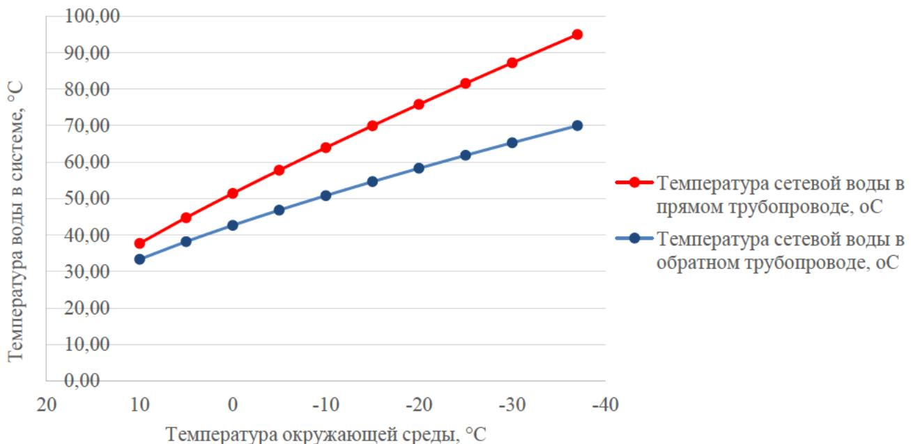
Рисунок 2.2 – График изменения температур теплоносителя (температурный график 95/70°C)
