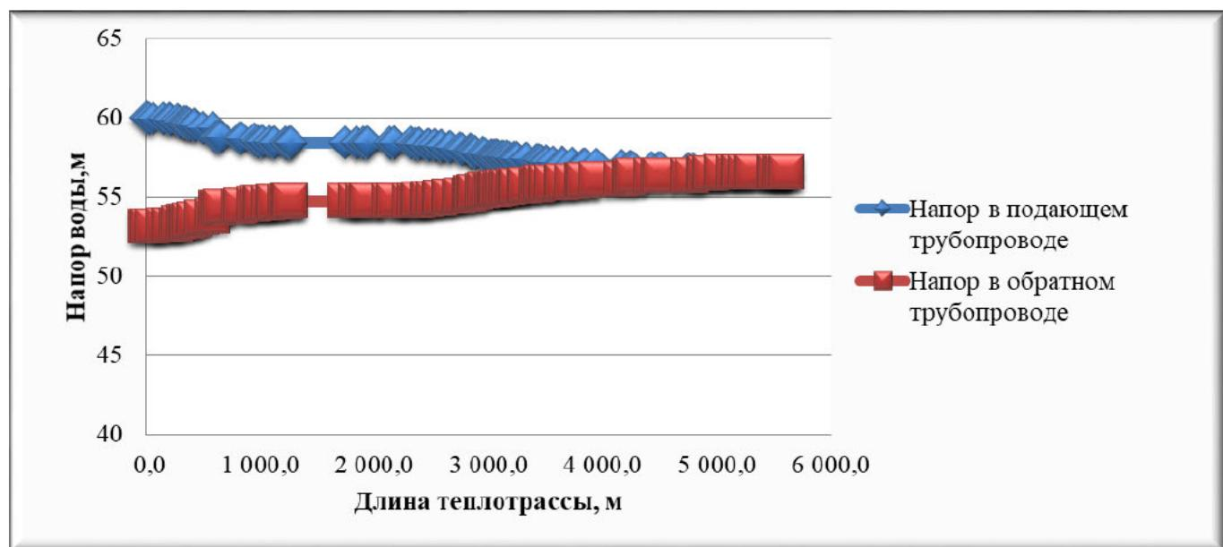
Рисунок 2.3 – Пьезометрический график тепловой сети котельной «Микрорайон»
