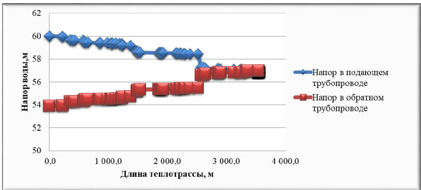
Рисунок 2.7 – Пьезометрический график тепловой сети котельной «Тамерлан»
