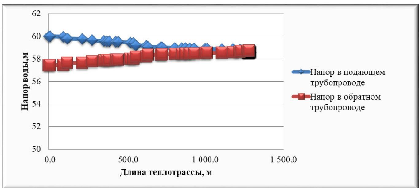
Рисунок 2.5 – Пьезометрический график тепловой сети котельной «Больница»
