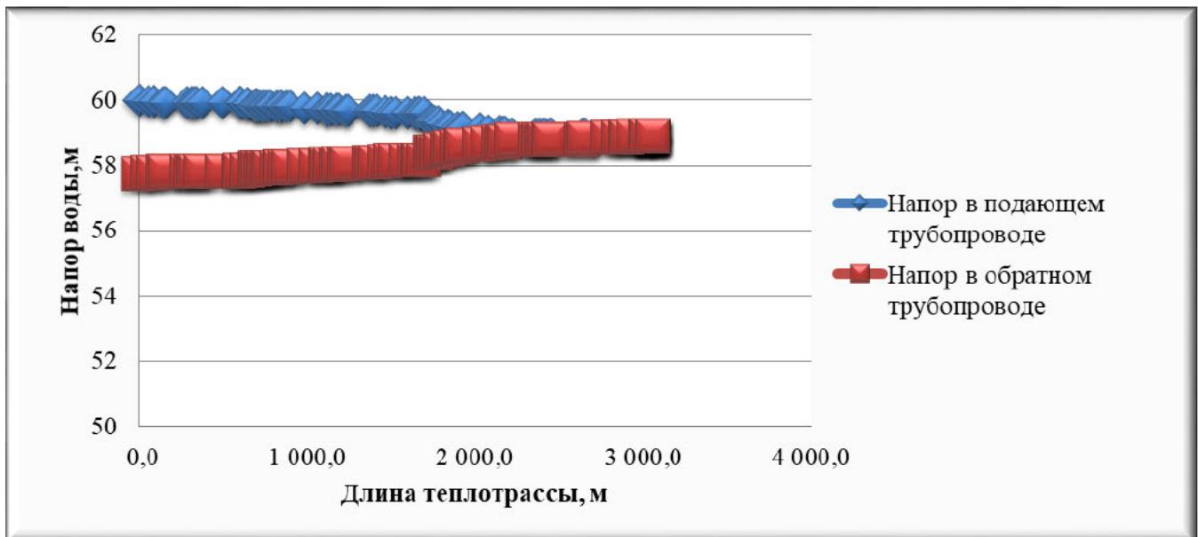
Рисунок 2.4 – Пьезометрический график тепловой сети котельной «Набережная»
